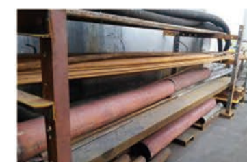
改善后图片（炼焦分厂捣固焦炉中石维修点）：现场管道、备件等使用专用架子摆放整齐
